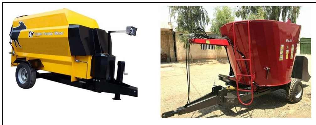
شکل ۱- ماشین خوراک‌ساز دام با مارپیچ عمودی (سمت راست) و مارپیچ افقی (سمت چپ) Fig. 1- Feeder mixer machine with vertical auger (right) and horizontal auger (left)
