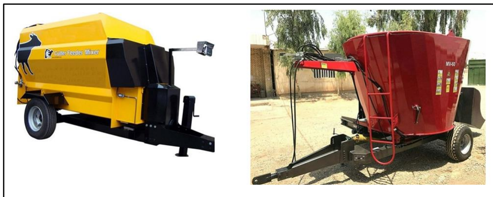
شکل ۱- ماشین خوراک‌ساز دام با مارپیچ عمودی (سمت راست) و مارپیچ افقی (سمت چپ)
