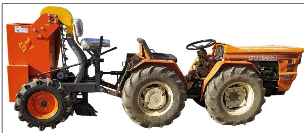
شکل ۴- ماشین پشت تیلری کارنده سیر با موزع پیاله‌ای و نحوه اتصال به تراکتور باغی
