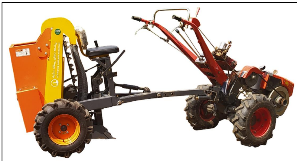
شکل ۳- ماشین کارنده سیر با موزع پیاله‌ای و نحوه اتصال به تیلر
