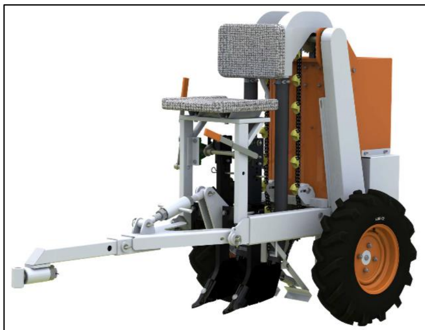
شکل ۲- نمای کلی ماشین کارنده پشت تیلری سیر (دید از چپ)
