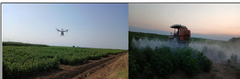
شکل ۲- سمپاش پشت تراکتوری بومدار و پهنپاش سم پاش مورد استفاده در این پژوهش Fig. 2- Tractor-mounted boom and drone sprayer used in this study
