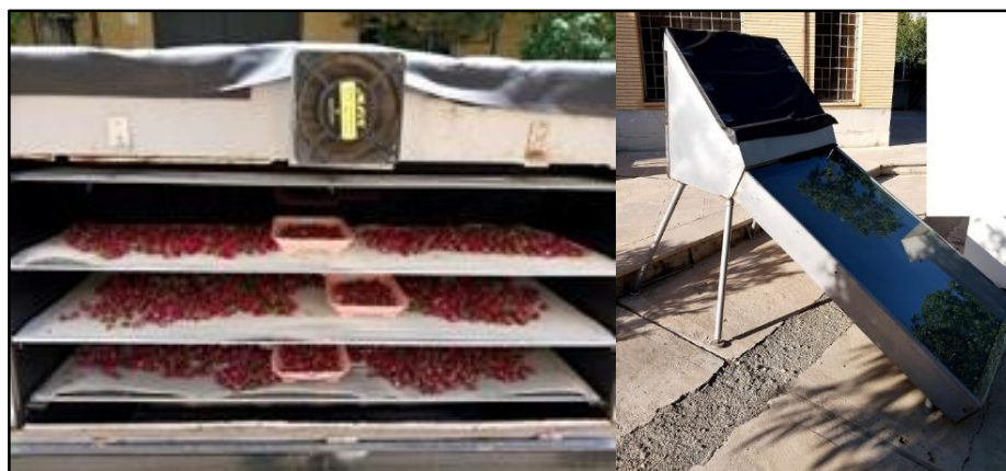
شکل ۲- خشک‌کن خورشیدی غیرمستقیم در حین فرآیند خشک‌کردن غنچه گل محمدی Fig. 2- Indirect solar dryer during drying process of Rosa flower bud
