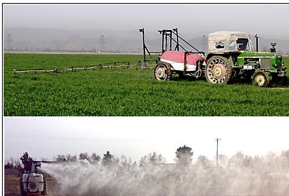
شکل ۲- سمپاش بوم‌دار پشت تراکتوری (بالا) و سمپاش توربولاینر (پایین)
