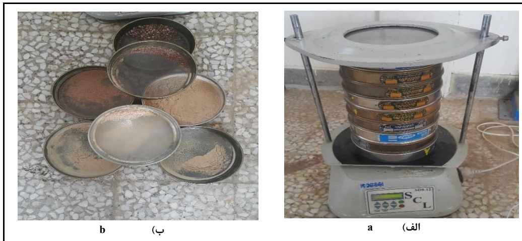
شکل ۲- الف) دستگاه الک لرزان و ب) غربال‌های استفاده شده برای الک لرزان Fig. 2- a) Vibrating sieve device and b) sieves used in the device
