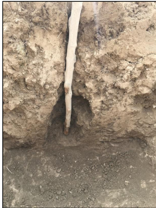
شکل ۹- پروفیل عمودی در محل تزریق مایع در خاک خشک
