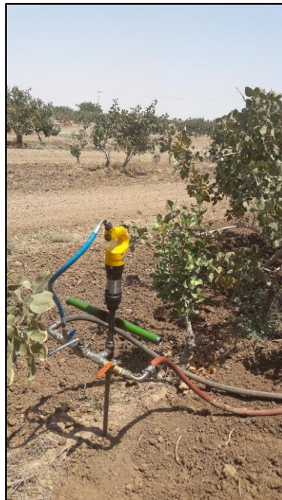
شکل ۳- نمونه نازل ساخته شده متصل به لوله‌های انتقال مایع و هوای فشرده و مجهز به چکش نیوماتیکی
