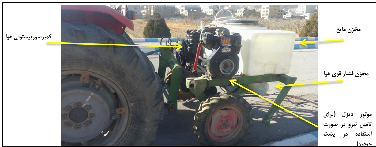
شکل ۱- دستگاه تزریق پشت تراکتوری مورد استفاده در آزمایش
