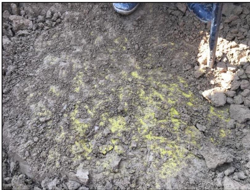
شکل ۵- ردیابی پخش مایع رنگی (نقاط زرد رنگ) در صفحه افقی در عمق تزریق
