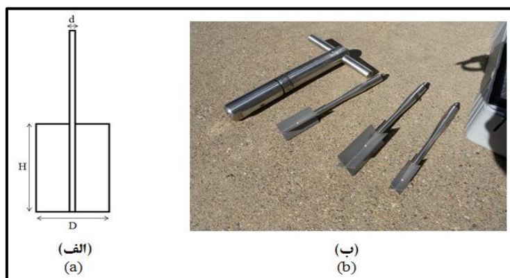
شکل ۳- الف) شمایی از دستگاه برش پره‌ای وین (D: قطر پره، H: ارتفاع پره، d: قطر محور پره) و ب) دستگاه برش پره‌ای وین مورد استفاده در این پژوهش
