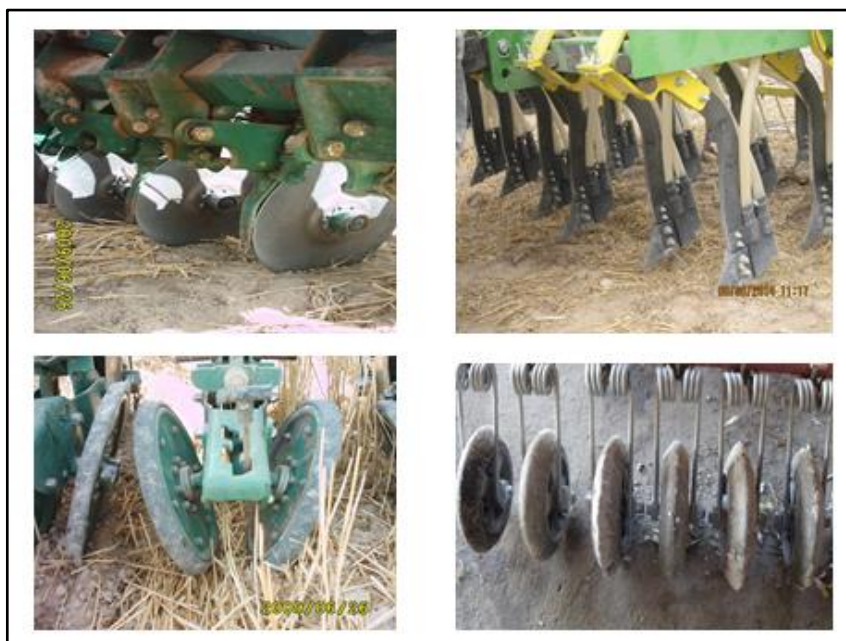
شکل ۱- شیاربازکن و چرخ‌های فشار مورد استفاده در کارنده‌های کاشت مستقیم Fig. 1- Furrow opener and press wheel used for no-till planter
