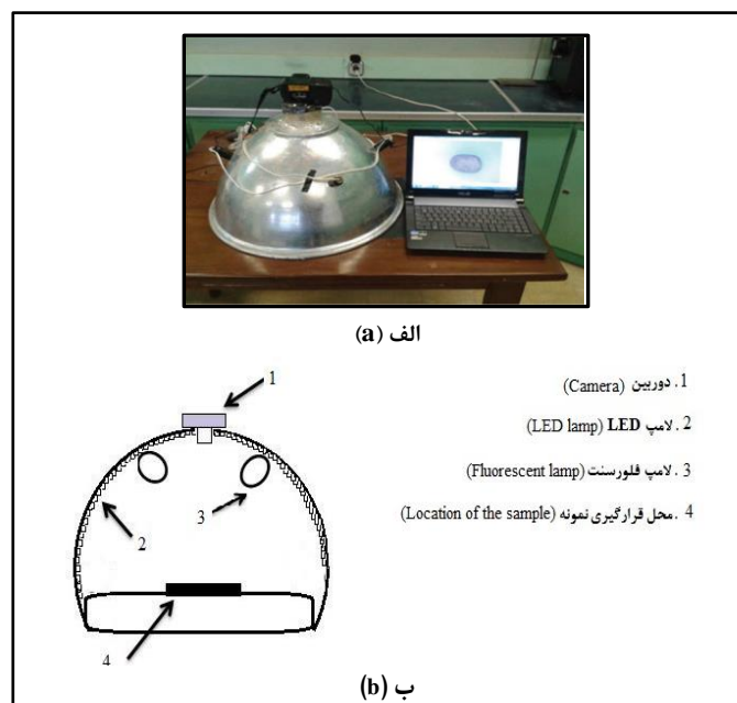
شکل ۱- الف) محفظه نورپردازی و ب) شماتیکی از محفظه نورپردازی و موقعیت قرارگیری لامپ‌ها در آن Fig. 1. a) Lighting chamber and b) Schematic of lighting chamber and the standing position of lamps in it
