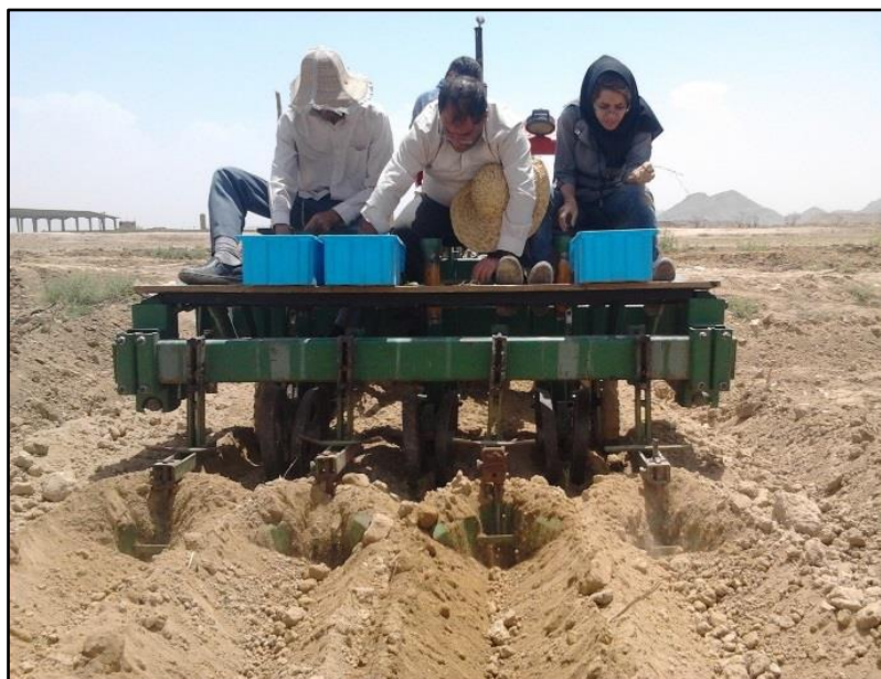
شکل ۲ - نشاکار مجهز به سامانه سقوطی به انضمام فاروئرهای متصل روی یک شاسی مجزا در عقب Fig. 2- Transplanter with seedling delivery tubes (gravitational) and furrowers on a separate tool-bar
