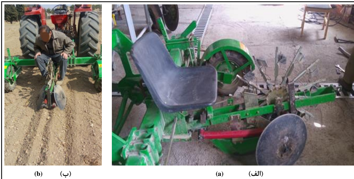
شکل ۱ - الف) نشاکار انبرکی با سامانه انتقال چرخ انگشتی و ب) جایگزین کردن چرخ‌های فشار با دیسک‌های پشته‌ساز Fig. 1- a) Transplanter with rotary gripper planting unit and b) press wheels replaced with double disk ridger
