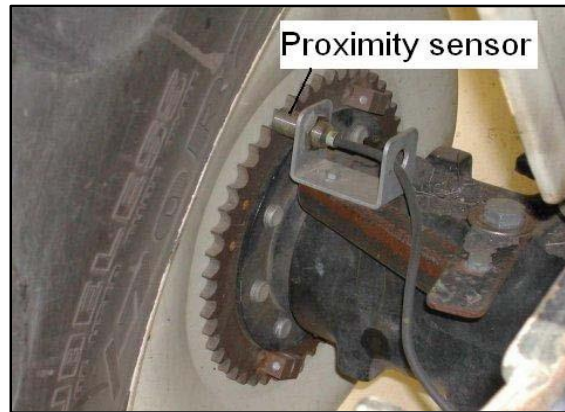
شکل ۲- حسگر سرعت چرخ برای اندازه‌گیری چرخش چرخ محرک Fig. 2- Wheel speed transducer for measuring the tire rotation
