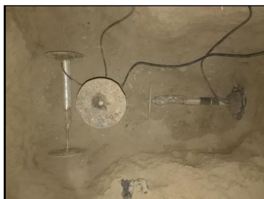
شکل ۱- قرارگیری مبدل‌های جابه‌جایی به همراه صفحات انتهایی در داخل چاله آزمایشی در جهت‌های طولی، جانبی و عمودی
