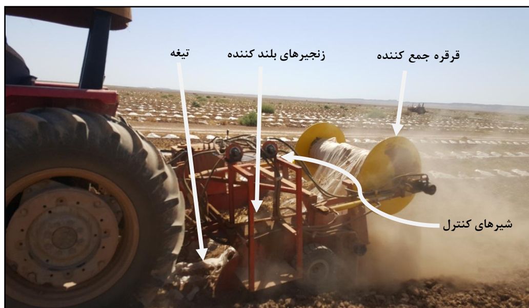
شکل ۱- نمایشی از دستگاه پلاستیک جمع‌کن در حین کار، تیغه و زنجرهای بلندکننده و شیرهای کنترل سرعت
