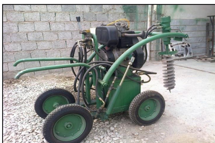
شکل ۲- مکانیزم محرک مته مارپیچ متشکل از موتور و واحد هیدرولیک و بازوهای هادی مته
