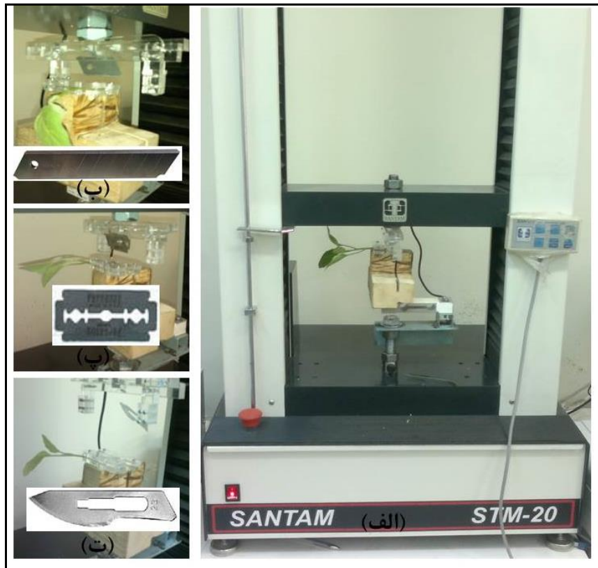
شکل ۳- الف) دستگاه آزمون مواد SANTAM STM-20 برای اندازه‌گیری نیروی برش ساقه نشا با سه نوع تیغه، ب) تیغه موکت‌بر، پ) تیغه ریش تراش و ت) تیغه جراحی (اسکالپل) که با فیکسچر روی دستگاه اینستران نصب گردید.
