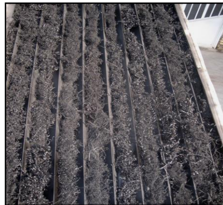
شکل ۳- صفحه جاذب شیاردار با پوشال فلزی
