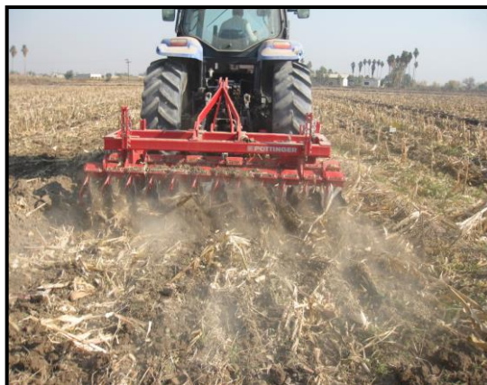
شکل ۱- ماشین تراDISK در حال تهیه زمین در بقایای ذرت
