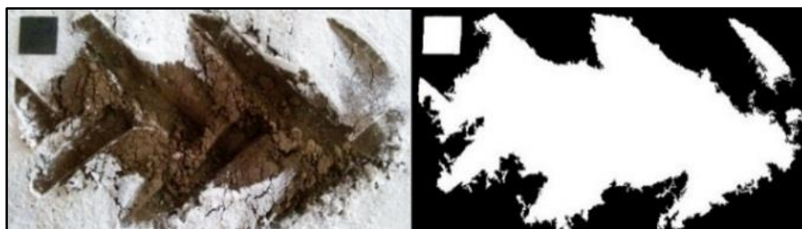
شکل ۲- رد اثر ایجاد شده روی خاک؛ فضای RGB (چپ) و فضای باینری (راست)
