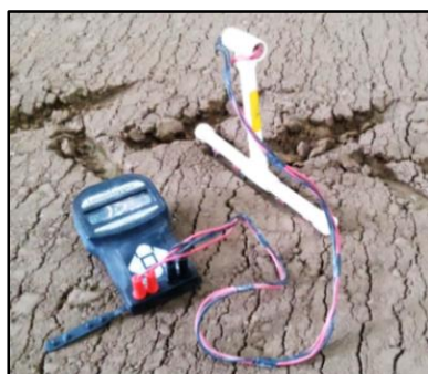
شکل ۴- اندازه گیری هدایت الکتریکی در زیر رد اثر آج لاستیک
