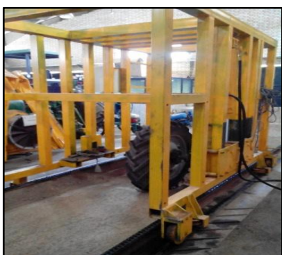
شکل ۷- قاب فلزی به همراه جک هیدرولیکی و تایر محرک
