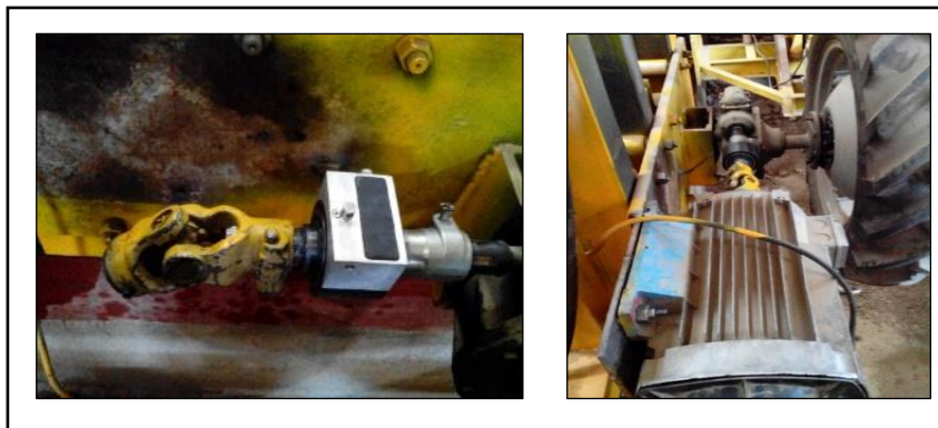
شکل ۸- گشتاورسنج Datum Electronics سری ۴۲۰
