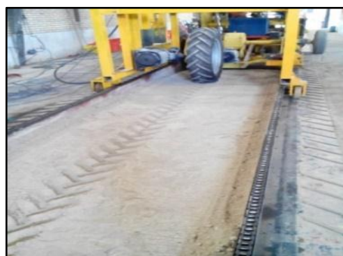
شکل ۶- دستگاه مخزن خاک آزمایشگاه دینامیک خاک
