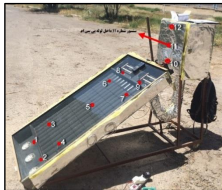
شکل ۴- خشک‌کن خورشیدی تکمیل شده و حسگرهای دما تعبیه شده روی آن
