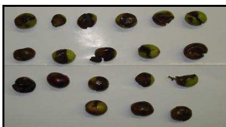
شکل ۱۰- نمونه میوه‌های آسیب دیده توسط دستگاه برداشت شانه چرخشی الکتریکی
