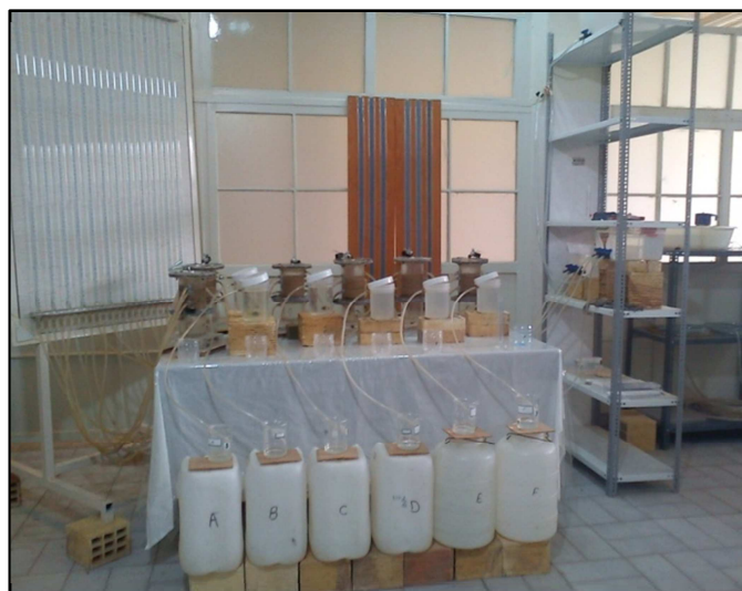
شکل ۳- دستگاه‌های نفوذسنج مورد استفاده در آزمون‌ها و ضمایم آنها
