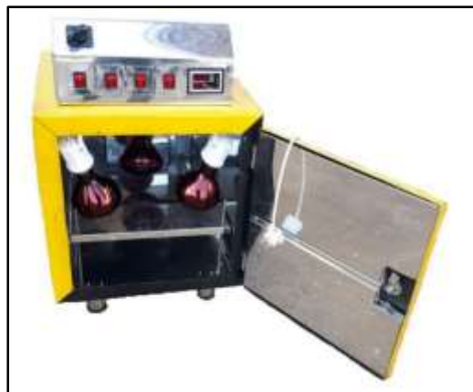
شکل ۳- خشک‌کن فرورسرخ مورد استفاده در پایش تیمار
