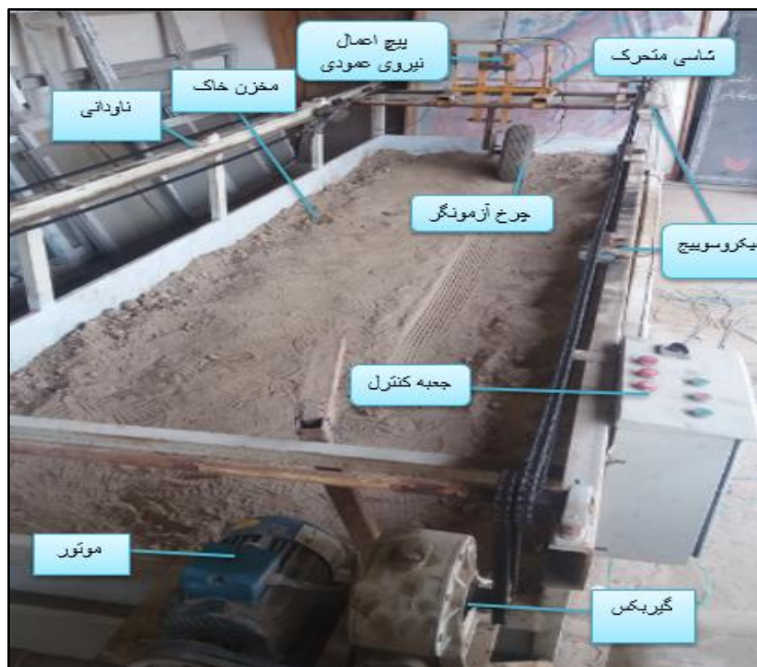
شکل ۱- اجزای تشکیل‌دهنده انبار خاک
