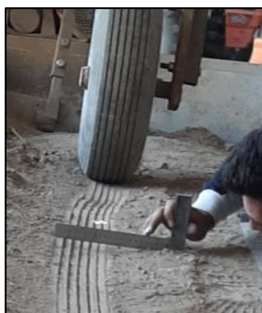
شکل ۶- اندازه‌گیری عرض تماس چرخ با خاک Fig. 6- Measuring the width of soil-wheel contact area
