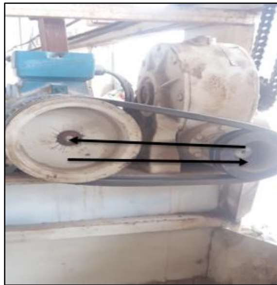
شکل ۲- پولی‌های جعبه دنده و موتور الکتریکی Fig. 2- Gearbox and electric motor pulleys
