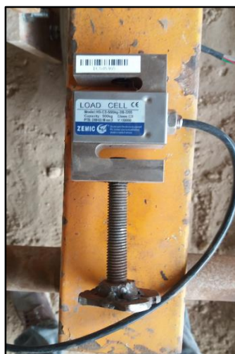
شکل ۳- لودسل ۵۰۰ کیلوگرمی Fig. 3- 500 kg loadcell
