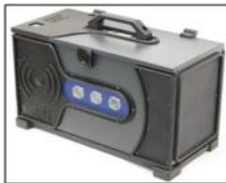
شکل ۲- دستگاه اندازه‌گیری آلاینده‌های خروجی اگزوز (MDS 418) Fig. 2- Exhaust emissions measuring device (MDS 418)
