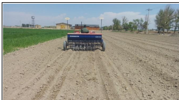
شکل ۱- قرار گرفتن چرخ‌های ماشین کاشت در دو طرف کرت آزمایش Fig. 1- Planting machine wheels on both sides of the experiment plots
