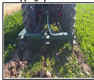
شکل ۵- غده‌کن تیغه‌ای در حال عملیات کندن نشا Fig. 5- Blade digger in digging seedling
