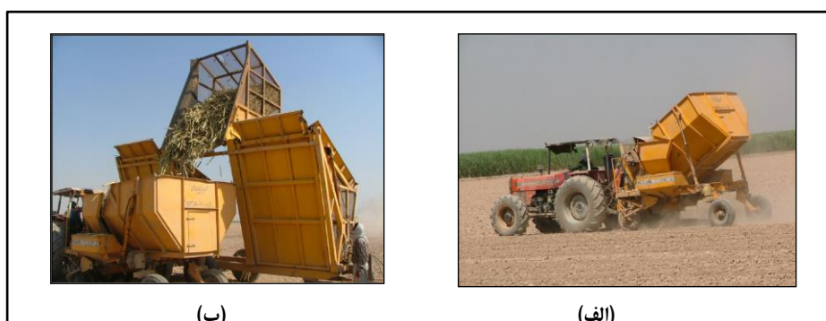
شکل ۳- قلمه‌کار ریزشی ماشینی سازی تبریز الف) در حال کار و ب) در حال بارگیری
