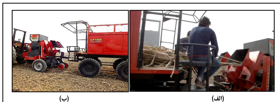
شکل ۲- الف) قلمه‌کار برنده-کارنده نیمه‌مکانیزه و ب) کارگران در حال گذاشتن نی به درون سامانه تغذیه و برش
