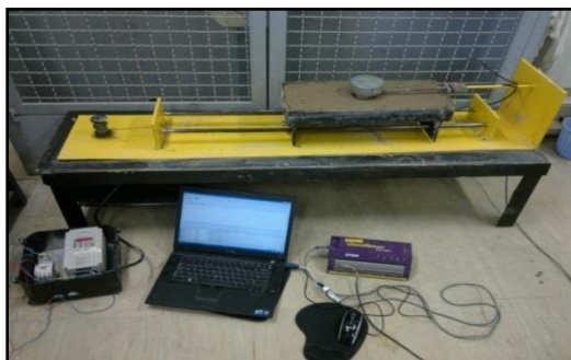
شکل ۴- نمایی از دستگاه مورد استفاده برای تعیین ضریب اصطکاک خاک و فلز و چسبندگی
