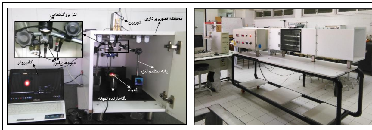
شکل ۱ - تصویر خشک کن مورد استفاده (تصویر سمت راست) و سامانه تصویربرداری پس پراکنش لیزر (تصویر سمت چپ)
