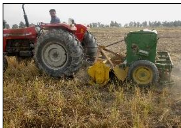
شکل ۴- ترکیب ماشین خاک‌ورز نواری و خطی کار غلات در حال کاشت گندم در بقایای برنج
