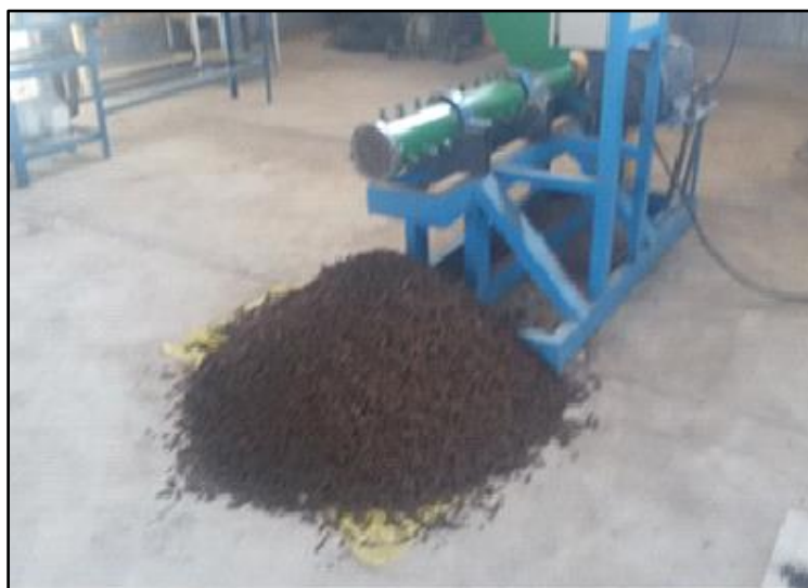
شکل ۳- تولید پلت با استفاده از دستگاه اکسترودر ورزدهنده
