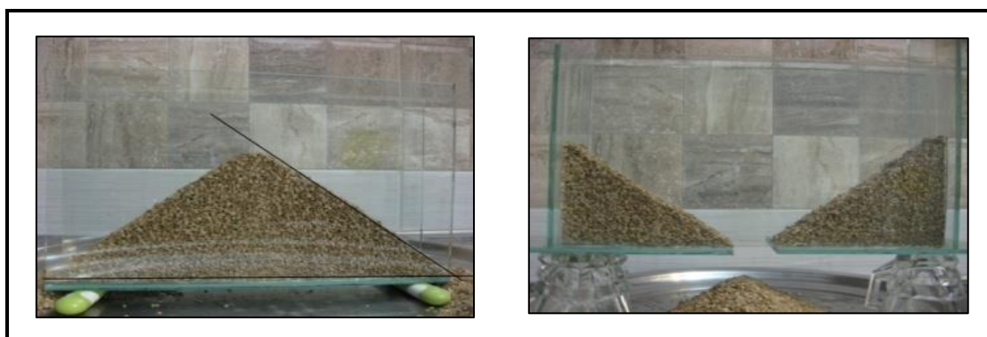
شکل ۶- روش‌های اندازه‌گیری زاویه استقرار
