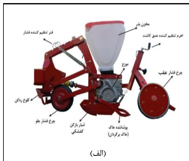
شکل ۱- قسمت‌های مختلف کارنده نیوماتیکی تراشکده (الف) و کارنده صنعت کاران دزفول (ب)
