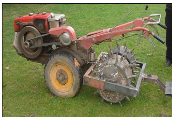
شکل ۸- ماشین هوادهی چمن ساخته شده
