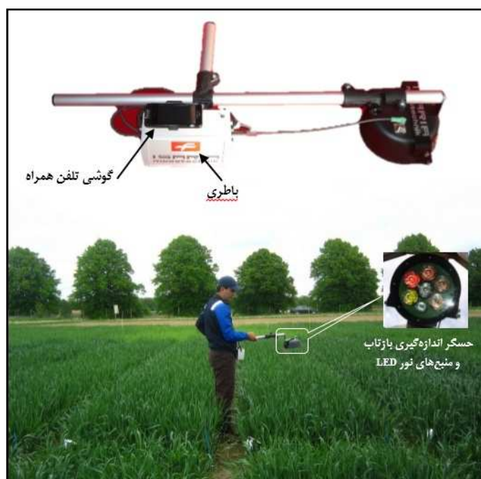
شکل ۲- اندازه‌گیری‌های غیرمخرب با استفاده از حسگر ISARIA
