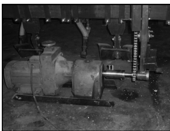
شکل ۳- اتصال مجموعه موتور الکتریکی و جعبه‌دنده به جای چرخ زمین‌گرد
